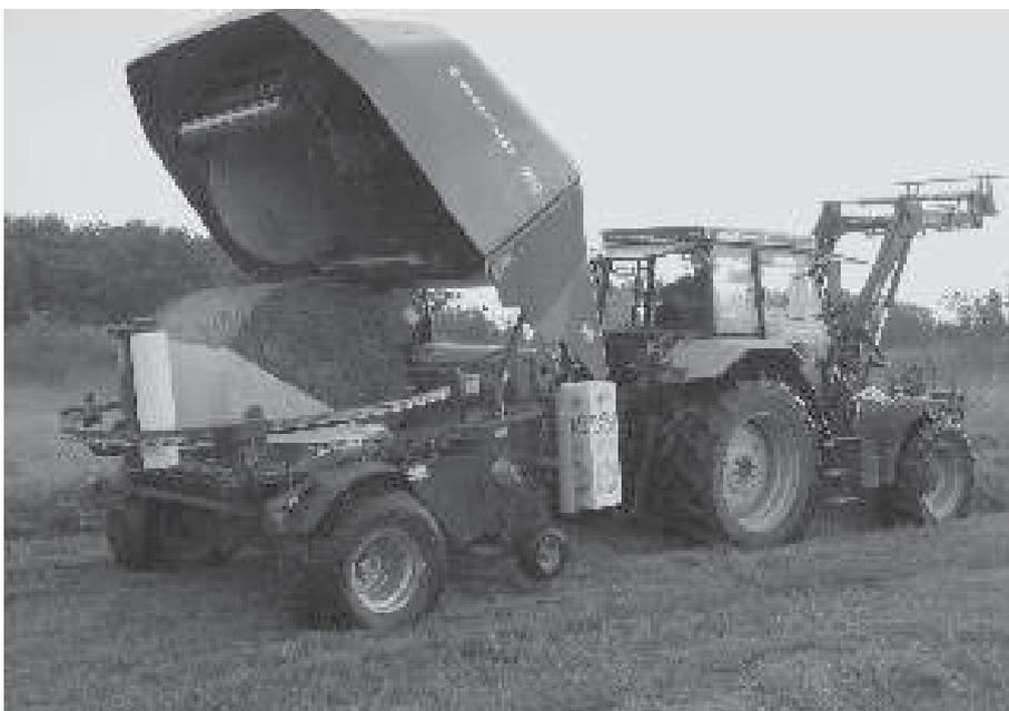
Schlepper befahrbar sind, fast ausschließlich mit einer Rundballenpresse. Diese Art der Mähgutkomprimierung und -bergung hat viele Vorteile. Insbesondere kann in dieser Form eine Verwertung zu Futter- oder
